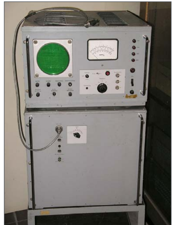
Abb. 11: Ur-Lautheitsmesser in analoger LC-Technik, © T. Zwicker
