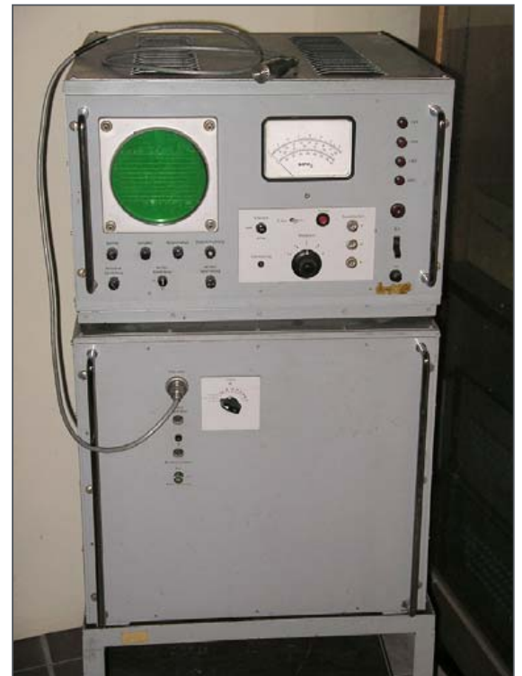
Abb. 11: Ur-Lautheitsmesser in analoger LC-Technik, © T. Zwicker
