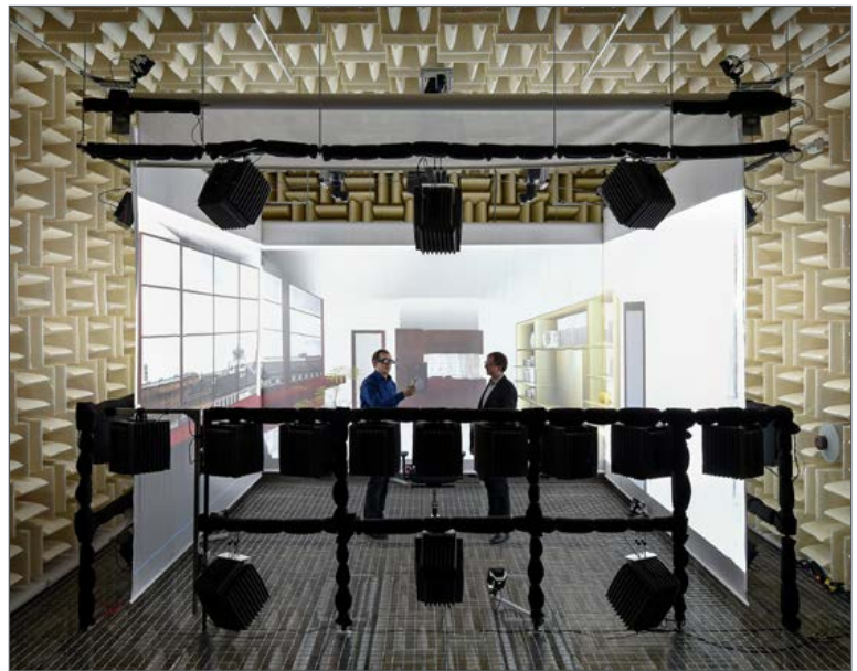
Abb. 2: Beispielhaftes audiovisuelles Interaktionsszenario in der real-time Simulated Open Field Environment im reflexionsarmen Raum an der TUM.
