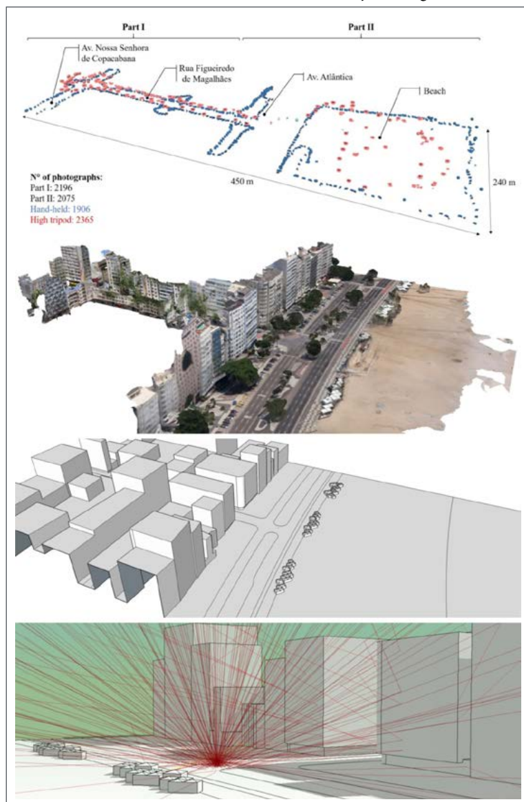
Abb. 3: Halbautomatische Erstellung eines 3D-Modells für die Virtuelle Akustik des komplexen Szenarios am Strand von Copacabana, Brasilien. Von oben nach unten: Akustische und visuelle Datenerfassung, Photogrammetrisches Netz, akustisches Modell, akustisches Ray-Tracing.
