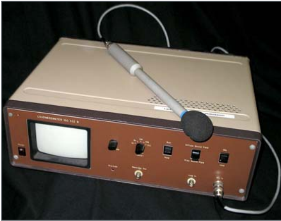
Abb. 12: Lautheitsmesser mit digitaler Signalverarbeitung, © T. Zwicker
