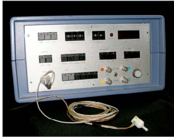
Abb. 13: Gerät zur Messung verzögerter, evozierter otoakustischer Emissionen (DEOAE), © T. Zwicker
