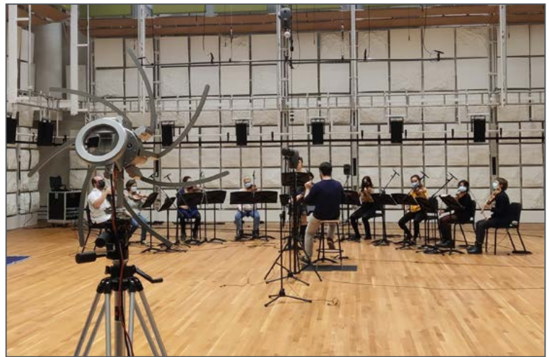
Abb. 3: Aufnahmen und akustische Messungen von Jithin Thilakan im Rahmen der Projekte ACTOR und VRACE an der McGill University, Montreal, zur Untersuchung der Vermischung von Instrumenten in variablen akustischen Umgebungen
