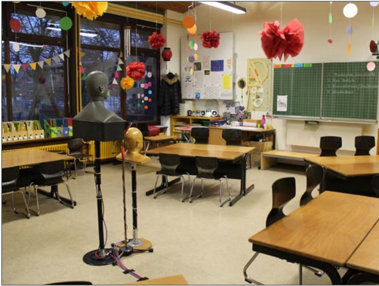
Abb. 1: Messaufbau von Karin Loh in einem Klassenzimmer
