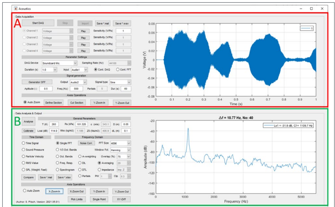
Abb. 5: Grafische Benutzeroberfläche der MATLAB toolbox „Acoustics“. Bereich A: Einstellung der Datenerfassung und Anzeige des Zeitsignals. Bereich B: Datenanalyse und Ergebnisanzeige.
