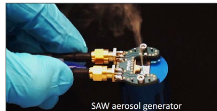
Zerstäubung durch SAW bei 43 MHz (Bild: Mehrzad Roudini, Leibniz Institute for Solid State and Materials Research, Dresden; aus Winkler et al., Biomed Microdevices (2017) 19: 9)
