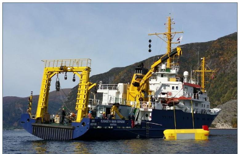
Abb. 7: FS ELISABETH MANN BORGESE (IOW, Warnemünde) beim Einholen des FLAME-Schleppkörpers (Flow-Noise Analysis and Measurement Equipment) während einer Forschungsfahrt in den Sognefjord, Norwegen. Im Vordergrund erkennt man den FLAME Schleppkörper (gelb) mit der integrierten Linearantenne (grau), mit der das Wellenzahl-Frequenzspektrum in Abbildung 6 bestimmt wurde. Auf der gegenüberliegenden Seite vom Schleppkörper befindet sich die Messkonfiguration (vgl. Abb. 8).
