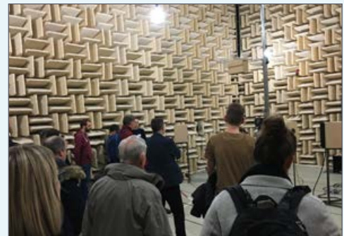
Besichtigung der Prüfräume am Institut für Arbeitsschutz der DGUV in St. Augustin während des Herbstworkshops 2019 zum Thema „Lärm am Arbeitsplatz“. Hier Vorführung der Gehörschützerprüfung im reflexionsarmen Halbraum
