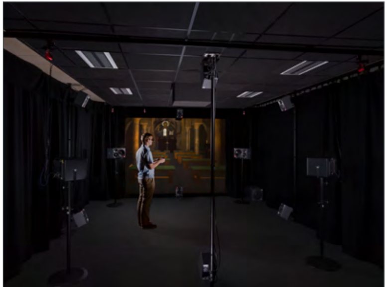
Abb. 6: Versuchsperson mit 3D-Brille in einem HOA-Lautsprecherarray.
