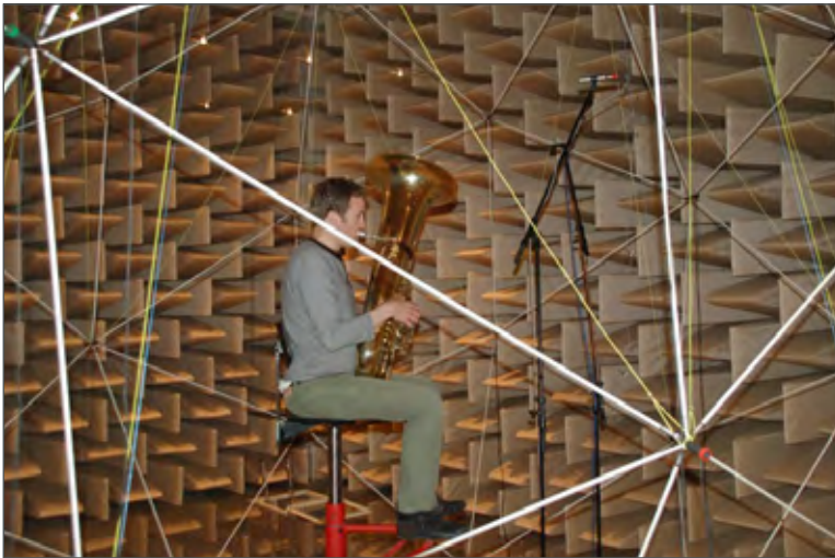
Abb. 5: Messung der Richtcharakteristik einer Tuba mit einem 32-kanaligen Mikrofonarray.
