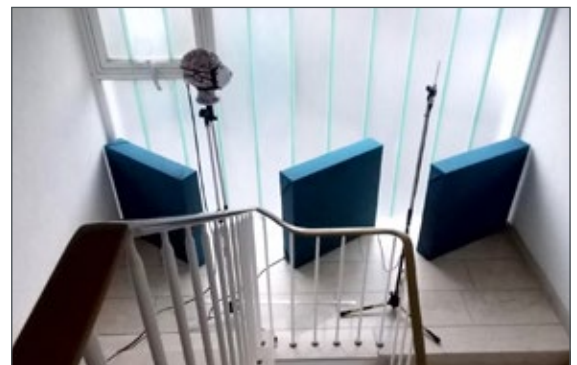
Abb. 6: Ansicht von Kopf mit FFP2-Einwegmaske mit Filter im modifizierten Treppenhaus, 1 m Abstand
