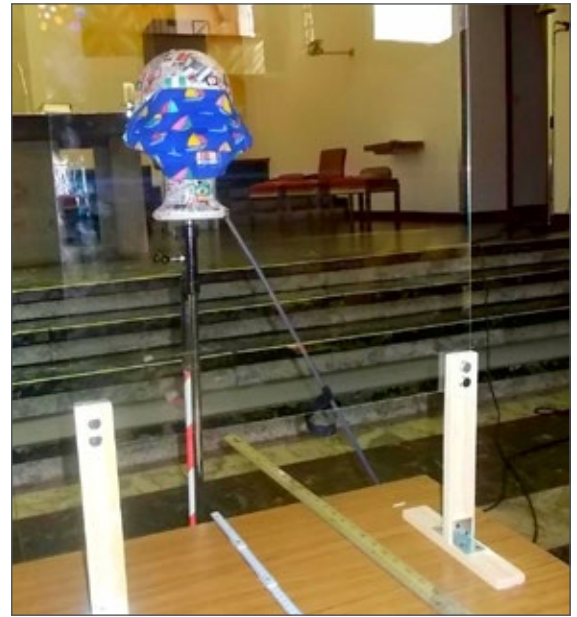
Abb. 4: Ansicht von Messlautsprecher mit Baumwollmaske samt Trennscheibe in der Kirche
