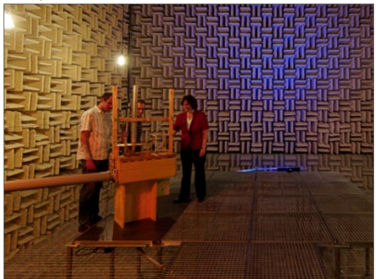
Abb. 5: Akustische Messungen im reflexionsarmen Raum des Fraunhofer IBP in Stuttgart.
