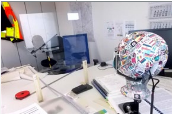
Abb. 1: Ansicht von Messlautsprecher und Einwegmaske samt Scheibe im Zweipersonenbüro
