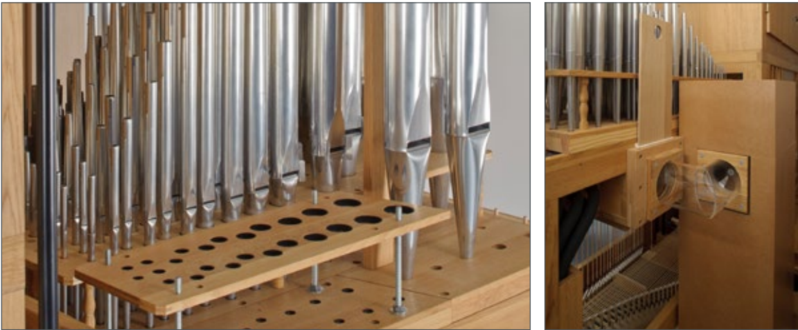
Abb. 20: Um neuartige Register testen zu können, steht eine Leerschleife zur Erprobung neu entwickelter Register mit in der Höhe regulierbarem Rasterbrett zur Verfügung (links); das Auslassventil mit Schalldämpfer, das als Teil des innovativen Windsystems montiert ist (rechts). (Fotos: Roman Wack, IBP)
