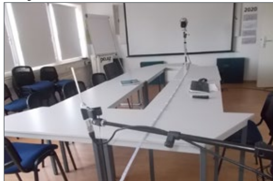
Abb. 2: Ansicht des Messlautsprechers im Besprechungsraum, 4 m Abstand
