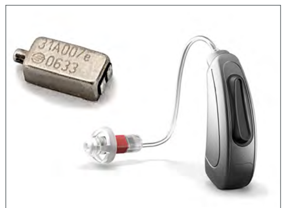
Abb. 5: Aktuelles Hörgerät [19] und vergrößert dargestellter BA-Lautsprecher [5].
