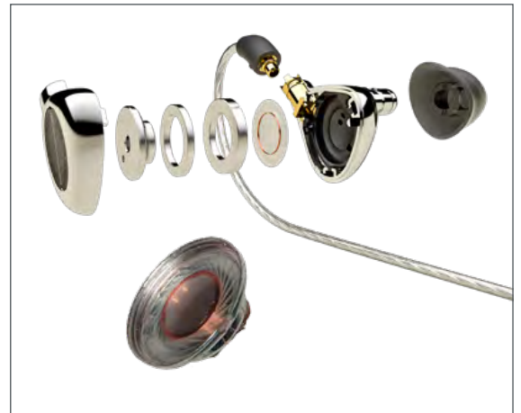
Abb. 4: Aktueller In-Ohr-Kopfhörer (Explosionszeichnung) [18] und vergrößert dargestellter elektrodynamischer Lautsprecher [5].
