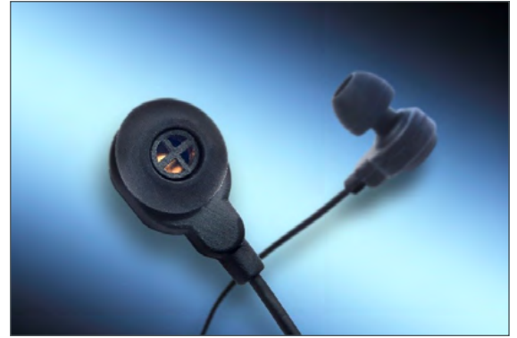
Abb. 16: 3D-gedruckter In-Ohr-Kopfhöreremonstrator mit integriertem MEMS-Lautsprecher [37].
