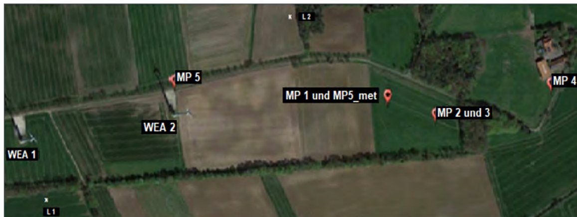
Abb. 1: Übersicht der Messpunkte mit Position WEA1 und 2 und LiDAR L1, L2. (Quelle: Google Earth)
