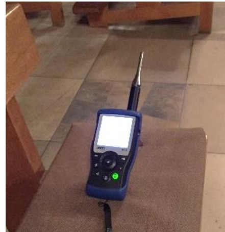
Abbildung 1.5 - Messung des Ruhepegels
