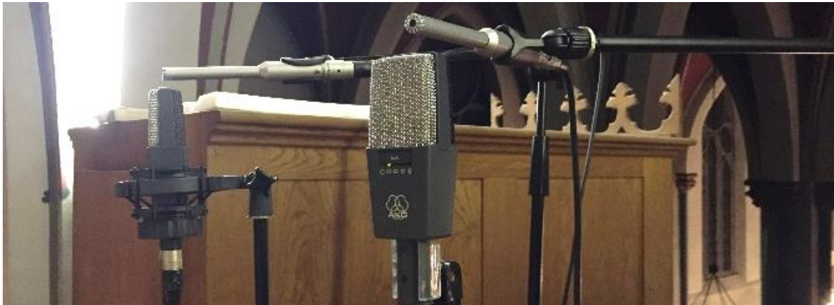
Abbildung 1.3 - Mikrofonierung des Hauptwerkes mit AKG C414 und kalibrierten Referenz-Messmikrofonen
