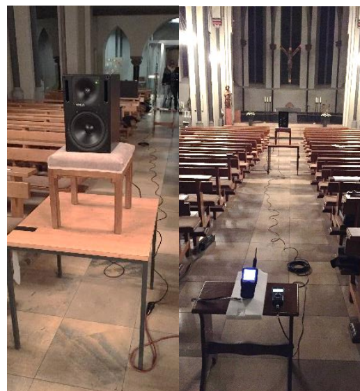
Abbildung 1.6 - Messung der Nachhallzeit: Lautsprecher zum Altar gerichtet (links), Messgerät ca. 7 m hinter dem Lautsprecher (rechts)
