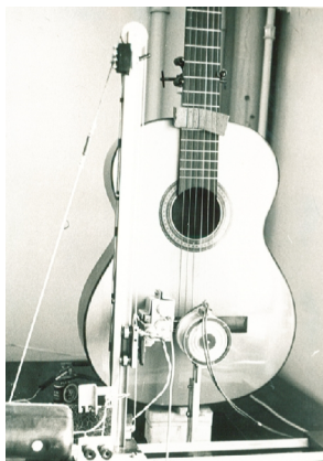
Abbildung 5: Gitarre mit elektrodynamischen Anregesystem
