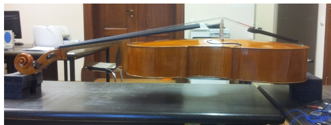
Abbildung 1: Cello frei gelagert auf Schaumstoff für die Übertragungskurvenmessung
